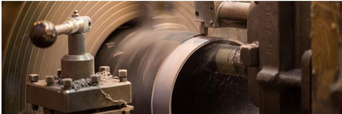
Tufcot® je lako obradiv uobičajenim metodama strojne obrade i načelno se može usporediti sa strojnom obradom mesinga ili gvajaka (lignum vitae/drvo života), ali se treba obrađivati bez upotrebe rashladne tekućine.
